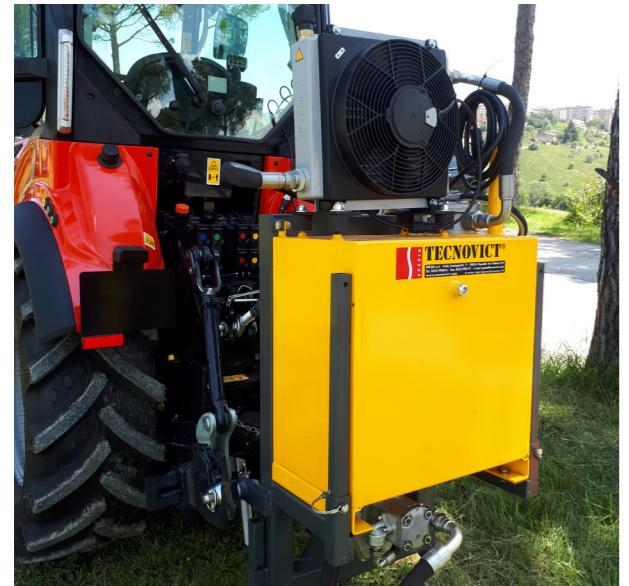
La centralina idraulica posteriore è altamente consigliata per garantire un corretto flusso di alimentazione ai coltelli ed ai movimenti idraulici e nel contempo assicurare il corretto raffreddamento dell'impianto.
